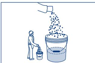
3. Transcurridos los 5 minutos mencionados, introducir un agitador mecánico y mezclar entre 1 a 3 minutos hasta obtener una pasta homogénea y libre de grumos.
